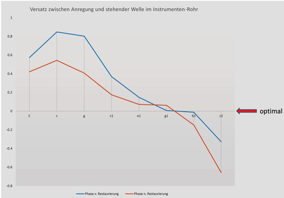
**ABBILDUNG 6** Bei fast allen Frequenzen ist der zeitliche Versatz zwischen Schwingungsanregung und Schallfeldschwingung nach der Restaurierung deutlich reduziert. Die Töne können somit sicherer angespielt werden.
